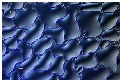
Fig. 8 Deposito uniforme nanoparticelle TiO2
