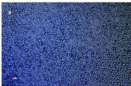
Fig. 7 Distribuzione gocce con Spray a turbina
